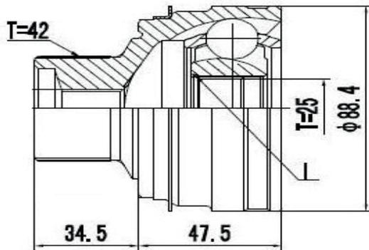
Automático Audi Q5 2.0 16V 4X4 Tfsi (13...) (42 Roda X 25 Câmbio X Trava IL)
