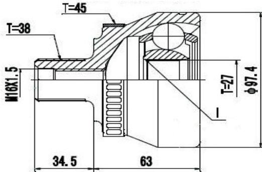
Passat Alemão 1.8 20V (98...05), Passat Alemão 2.8 V6 30V (97...03), Pointer 1.8/2.0 (94...96) (38 Roda X 27 Câmbio X 45 Abs X Trava IL)
