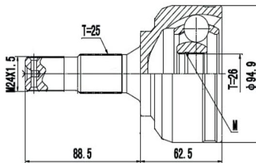
C5 3.0 V6 Automático (01...08), Aircross Automático (17...) (25 Roda X 26 Câmbio X Trava ML)
