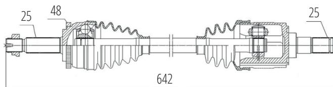
Esquerdo Manual Hb20X 1.6 (14...) (25 Roda X 25 Câmbio X 48 Abs X 642mm)
