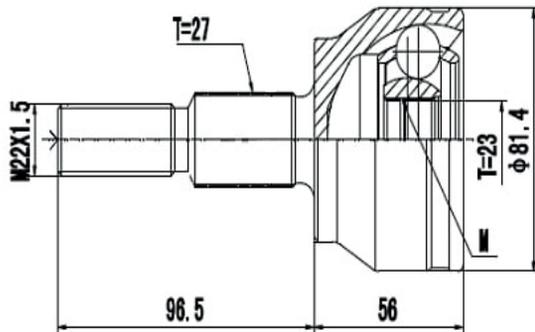
Focus 2.0 Automático (14...), Focus 1.6 16V Automático Power Shift (14...16)
