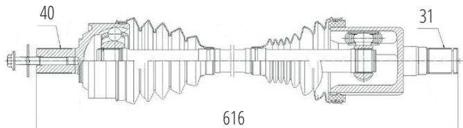
Dianteiro Esquerdo XC90 2.0T (17...) (40 Roda X 31 Câmbio X 616mm)
