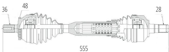
Dianteiro Esquerdo XC90 4.4 (...07) (36 Roda X 28 Câmbio X 48 Abs X 555mm)
