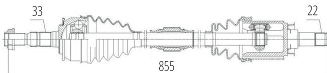
Direito Automático Onix 1.0/1.0 Turbo LT/LTZ/Plus (19...) (33 Roda X 22 Câmbio X 855mm)
