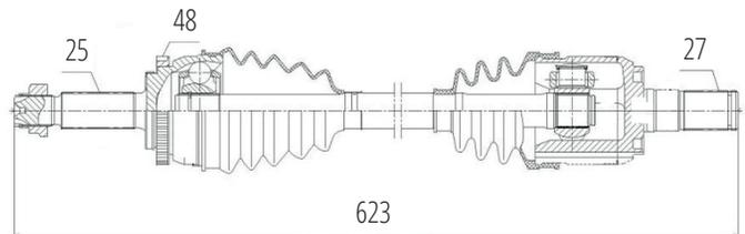
Esquerdo Automático HB20 1.6 (18...19) (25 Roda X 27 Câmbio X 48 Abs X 623mm)
