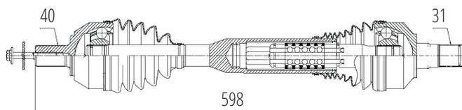
Dianteiro Esquerdo XC60 2.0T Automático (13...17), XC60 3.0T (13...17) (40 Roda X 31 Câmbio X 598mm)
