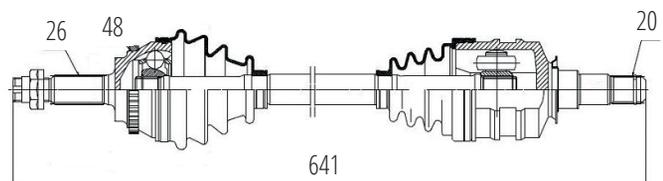
Esquerdo Corolla 1.6/1.8 16V Manual (02...08), Corolla 1.8 16V Automático (09...) (26 Roda X 20 Câmbio X 48 Abs X 641mm)
