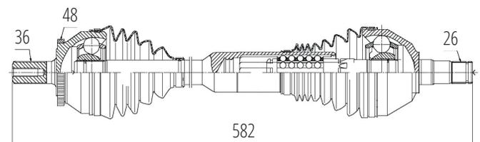
Dianteiro Esquerdo XC90 2.5T (...07) (36 Roda X 26 Câmbio X 48 Abs X 582mm)
