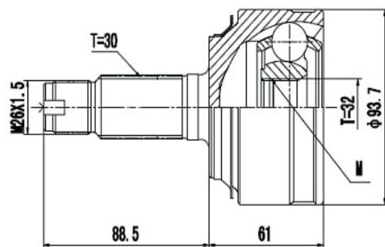
Dianteira CR-V 2.0 16V 4X2/4X4 Manual/Automático (09...12) (30 Roda X 32 Câmbio X Trava ML)
