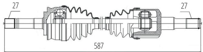
Esquerdo Ranger 4X4, Explorer 4X4 (Com Roda Livre) (27 Roda X 27 Câmbio X 587mm)
