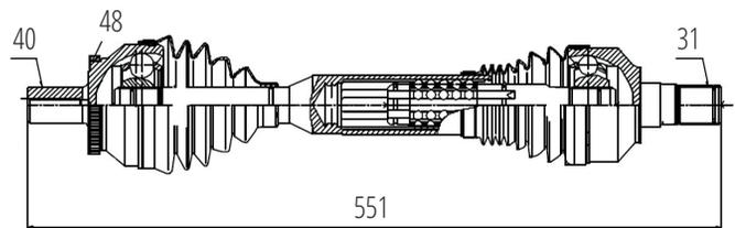
Dianteiro Esquerdo XC90 4.4 (07...14) (40 Roda X 31 Câmbio X 48 Abs X 551mm)
