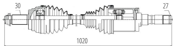
Dianteiro Esquerdo X5 (E70) 3.0/3.5/4.8/5.0 (08...13), X6 (E72) 3.0/3.5/4.8/5.0 (08...13) (30 Roda X 27 Câmbio X 1020mm)
