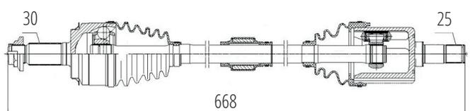
Esquerdo HR-V 1.8 Automático (16...) (30 Roda X 25 Câmbio X 668mm)
