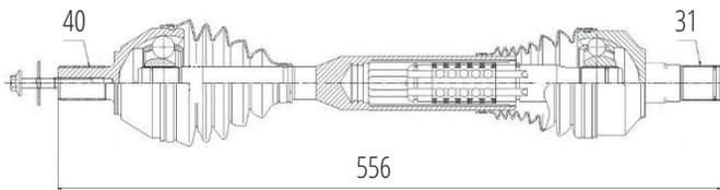
Dianteiro Esquerdo XC60 3.0T Automático (08...13) (40 Roda X 31 Câmbio X 556mm)
