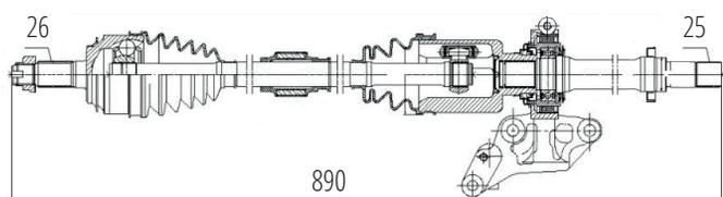
Direito Manual/Automático New Fit 1.4 (09...14), New Fit 1.5 (09...14), City 1.5 (09...14) (26 Roda X 25 Câmbio X 890mm)
