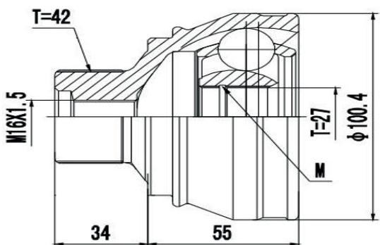
A4 1.8 TFS (07...), A4 2.0 TFSI (08...), A4 FSI 3.2 (09...) (42 Roda X 27 Câmbio X Trava ML)
