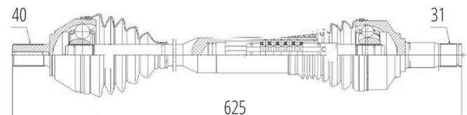
Dianteiro Esquerdo XC60 2.0T Automático (08...13) (40 Roda X 31 Câmbio X 625mm)
