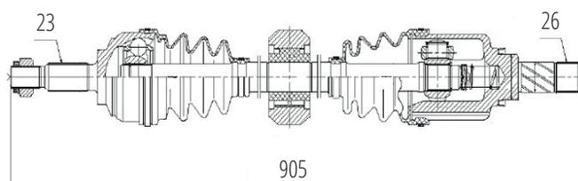
Direito Sandero II 1.6 16V H4M Automático (14...), Logan II 1.6 16V H4M Automático (14...) (23 Roda X 26 Câmbio X 905mm)
