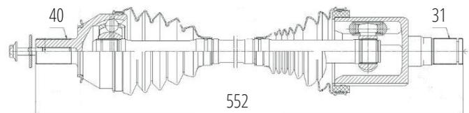
Dianteiro Esquerdo V60 2.0T (15...17) (40 Roda X 31 Câmbio X 552mm)
