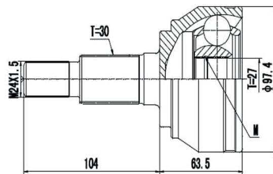
Automático Q7 3.0 (11...), Q7 3.6 (08...), Q7 4.2 V8 FSI (07...) (30 Roda X 27 Câmbio X Trava ML)
