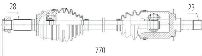
Traseiro Esquerdo CR-V 2.0 16V 4X4 Automático (09...) (28 Roda X 23 Câmbio X 770mm)
