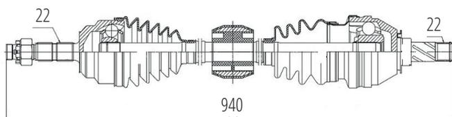
Direito Corsa 1.8 8V (02...07), Montana 1.8 8V (02...07) (22 Roda X 22 Câmbio X 940mm)
