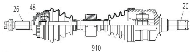
Direito Corolla 1.6/1.8 16V Manual (02...08), Corolla 1.6/1.8 16V Automático (09...) (26 Roda X 20 Câmbio X 48 Abs X 910mm)
