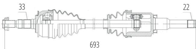
Esquerdo Automático Onix 1.0/1.0 Turbo LT/LTZ/Plus (19...) (33 Roda X 22 Câmbio X 693mm)
