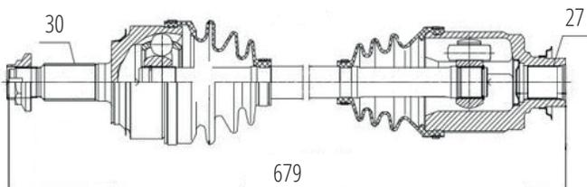
Dianteiro Esquerdo CR-V 2.0 16V 4X4 Automático (09...11) (30 Roda X 27 Câmbio X 679mm)
